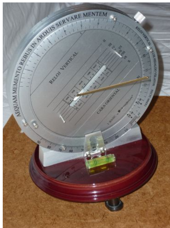
Figura 21b. Reloj de sol Foster-Lambert combinado con un direccional oriental-occidental (diseño de Luis Hidalgo, fotografía de Manuel Núñez)
