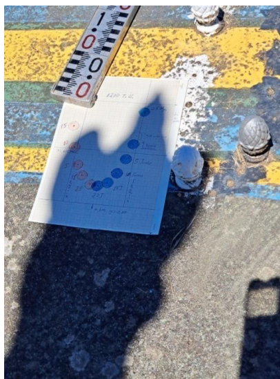
Figura 21. Fotografía realizada el 29 de mayo a las 14 horas y 46 minutos (hora oficial). Los círculos tienen un diámetro de 2 cm. Si se tiene en cuenta donde se ubica el punto señalizador (cuello del pájaro), se ve que la fecha está bastante bien señalizada. Claro que mejor sería haber dispuesto todo para que fuese el pico del pájaro el que señalase fechas y horas en estas fechas. El papel milimetrado colocado en el cuadrante es el de la figura 14.
