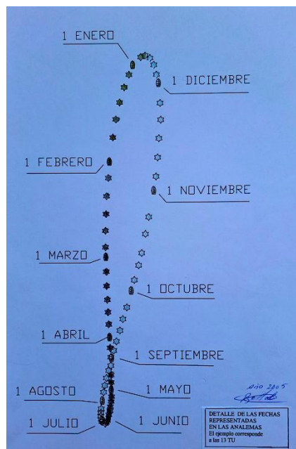
Figura 11. Plano a escala dibujado en un folio 4-A de la analema de las 13 TU del reloj-calendario solar de Castropodame. La escala es 1/25. Las estrellas pintadas sobre el cuadrante tienen un diámetro de 12 cm y el plano en papel está impreso a escala 1/25. La altura del objeto que da las sombras es de exactamente 3 metros. Es evidente que cerca del solsticio de verano las estrellas se confunden.
