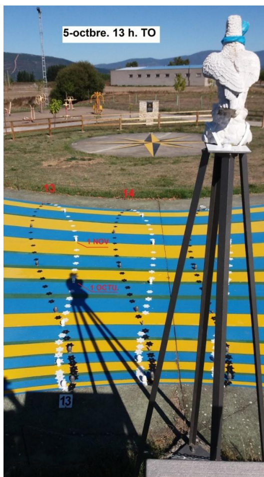
Figura 12. En este cuadrante el punto que sirve para indicar fechas y horas sería el ubicado en el centro del cuello del pájaro a la altura de la parte donde tiene atado ese lazo azul. Sobre cada analema los intervalos de las fechas son de 5 días.
